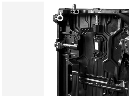
Verriegelung und rückseitiger Griff am Rental-Kabinett.
