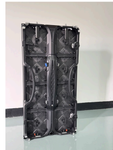
Rückseite: Schnellverschlüsse, Griffe, Durchschleifverkabelung
